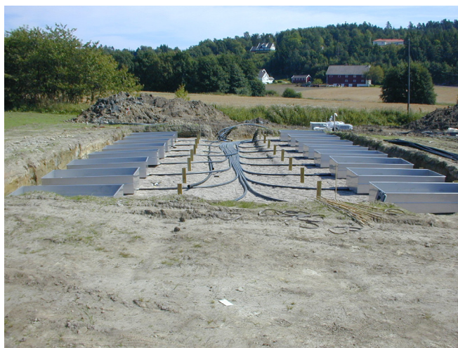
Bilde 4: Lysimeter-anlegget ved Bioforsk Turfgrass Research Center på Landvik ved Grimstad ble konstruert i 2003 for å måle avrenning av næringsstoffer og plantevernmidler fra sandbaserte golfgreener. Foto: Trygve S. Aamlid
